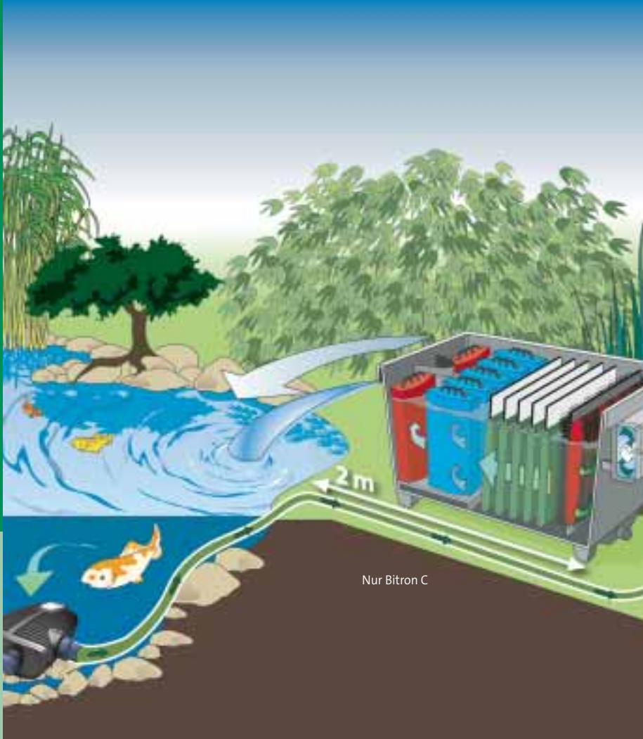
Schematische Darstellung: BioTec 30 in Funktion mit einer Filter- und Bachlaufpumpe und einem Bitron C
