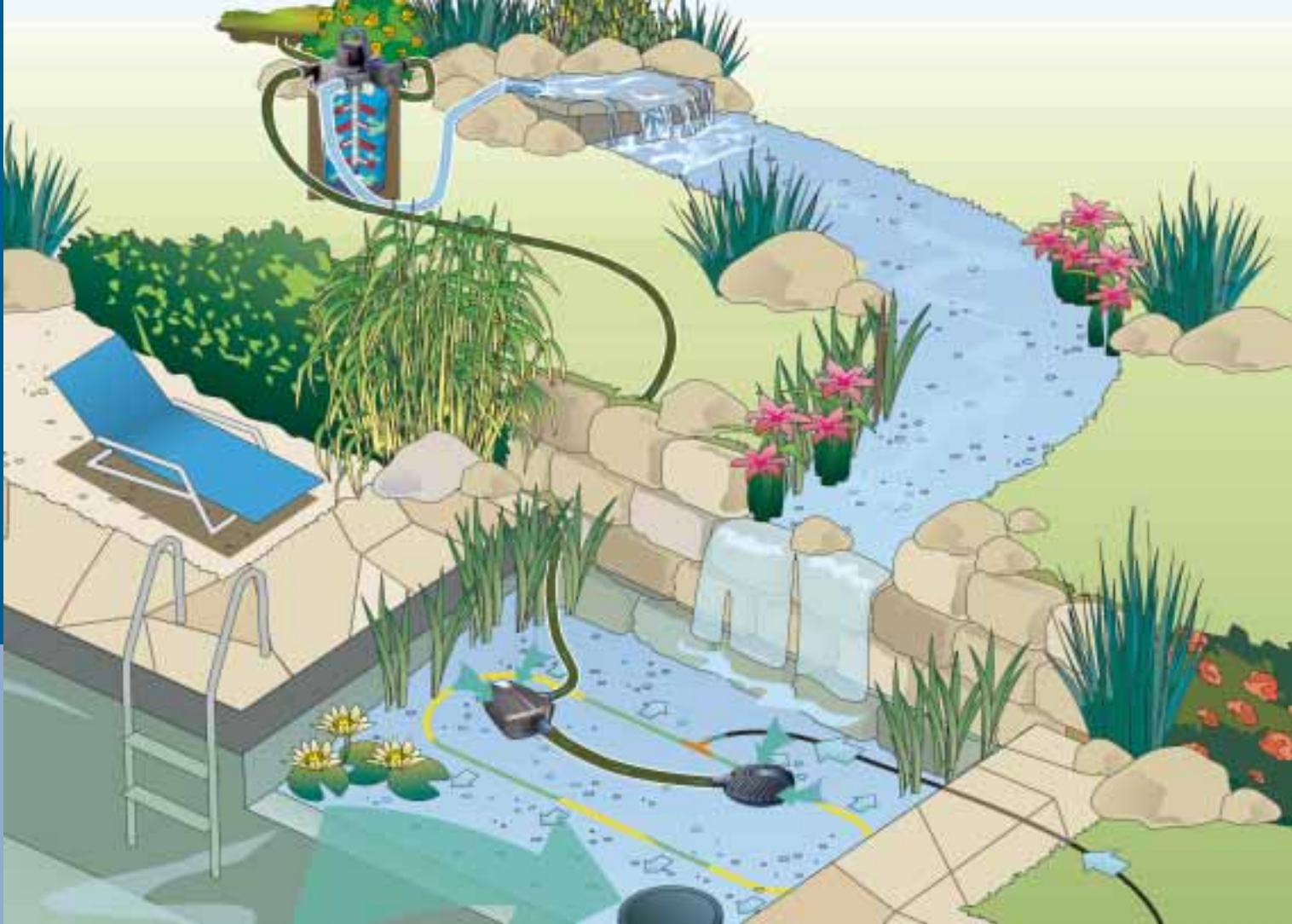
Schematische Darstellung: Filter- und Bachlaufpumpe AquaMax Eco Premium 12 V (PRO) eingesetzt im Schwimmteich in Kombination mit einem OASE-Druckfilter FiltoClear (PRO)
