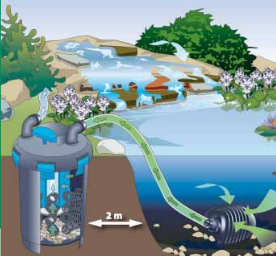
Schematische Darstellung: Druckfilter in Kombination mit Filter- und Bachlaufpumpe
