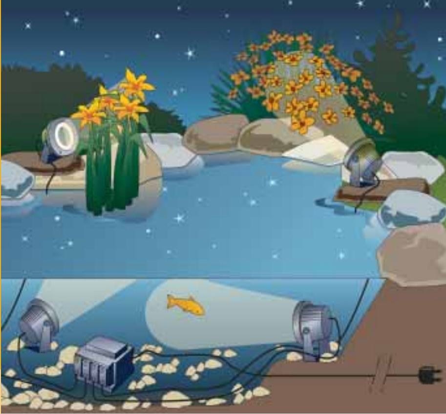
Schematische Darstellung: Halogen-/LED-Scheinwerfersysteme im Einsatz
