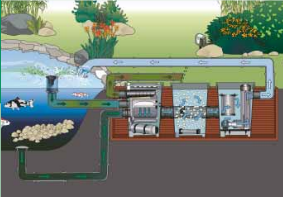
Schematische Darstellung: Modulfilter ProfiClear eignen sich hervorragend für den Einsatz an Koiteichen
