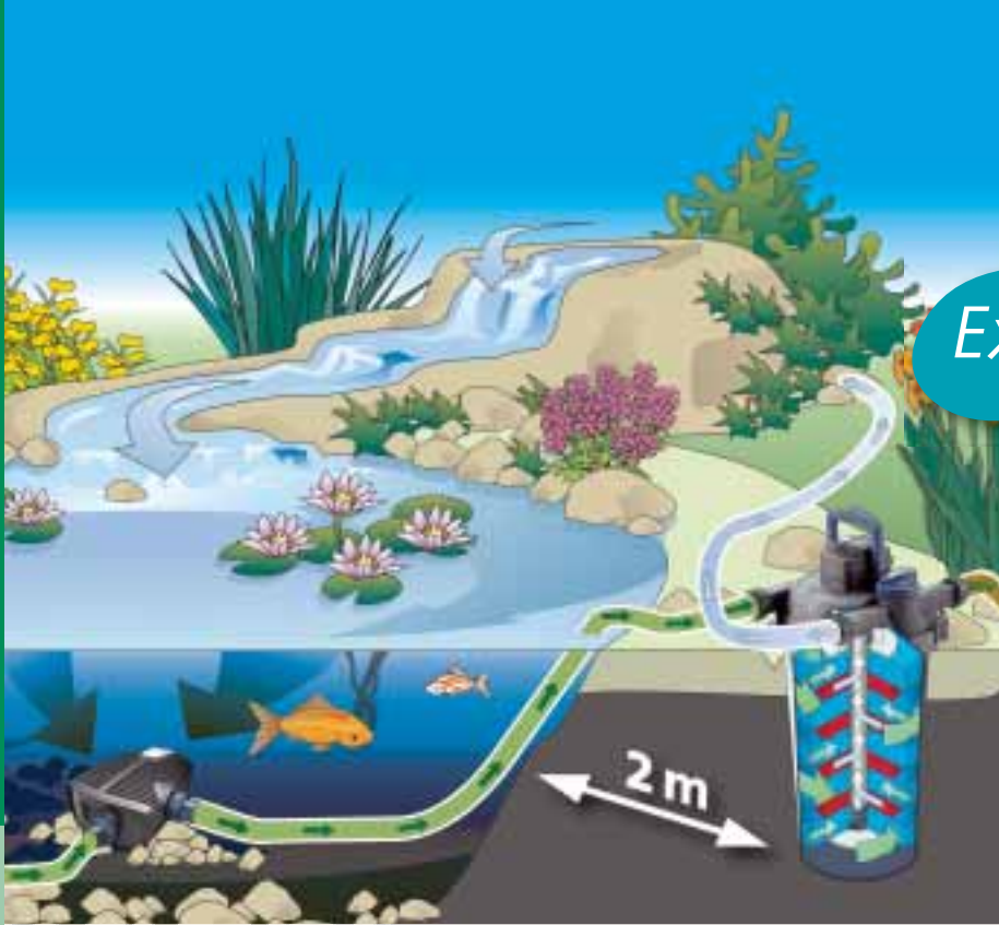
Schematische Darstellung: Druckfilter FiltoClear in Kombination mit Filter- und Bachlaufpumpe
